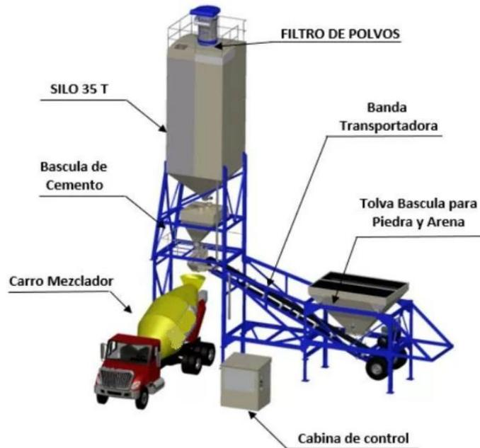
Para las plantas **RHO Serie RPDC – LT**, puedes utilizar un silo de almacenamiento adicional de manera vertical , antes de la bascula de cemento para mayor eficiencia.
